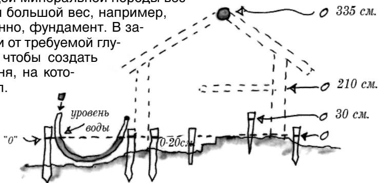
Расположите постоянные колышки уровней, чтобы выделить уровень готового пола для каждой основной комнаты и на окружающем участке
